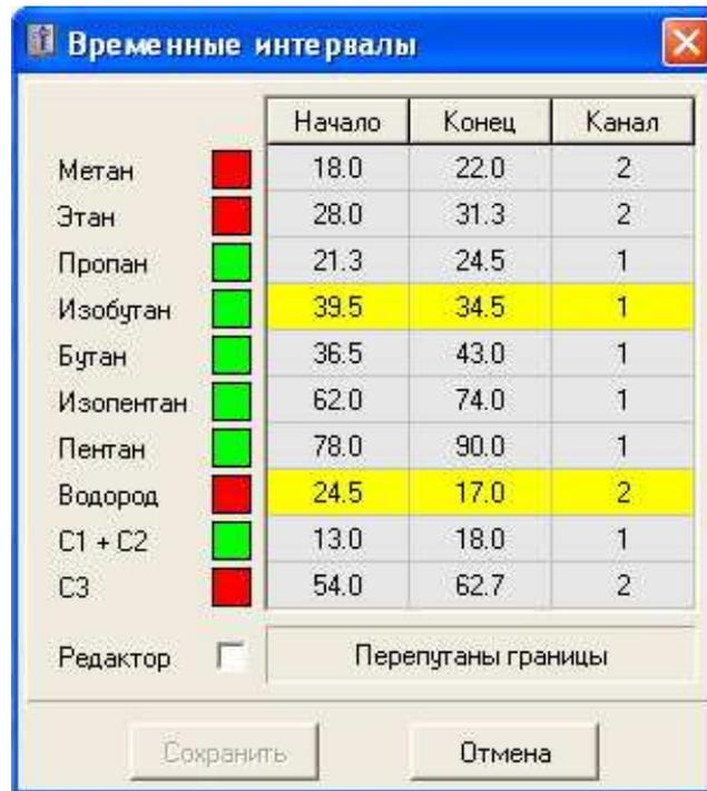
Рисунок 13 – Окно установки временных интервалов: индикация ошибок
